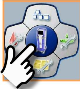
La touche Calibration figurant sur la barre des touches donne accès à la Carte des composantes de la calibration qui permet d'effectuer les calibrations et tests individuels.
